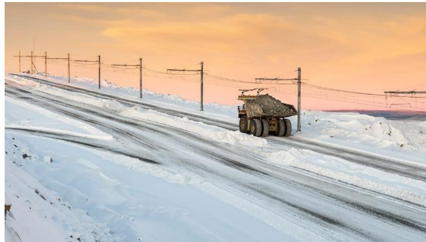
Camion minier électrique à caténaire, mine de fer de Boliden, Suède.
