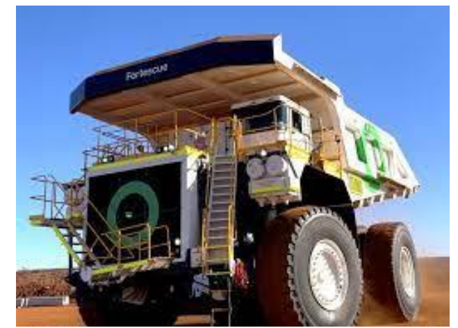
Camion minier électrique à batterie, Fortescue, Australie.
